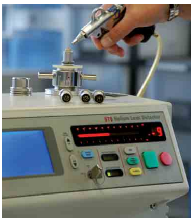
Vacuumtest with leakdetector Vakuumtest mit Leakdetektor
