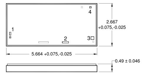
Unit: millimeters Material for carrier: Cu-Mo-Cu
