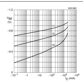
**TR2 (PNP);**  $V_{CE} = -5 \text{ V}.$
