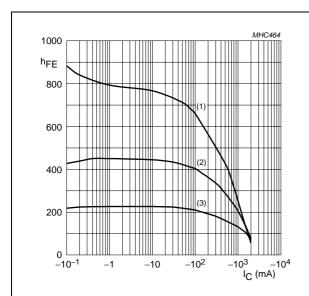
**TR2 (PNP);**  $V_{CE} = -5 \text{ V}.$
