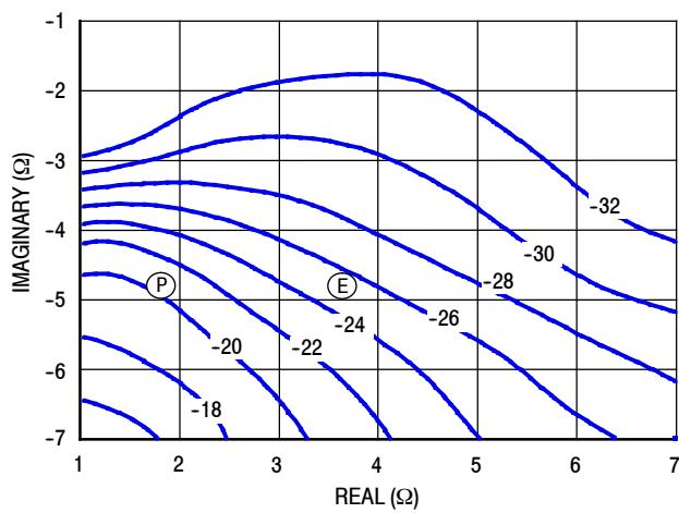
Figure 23. P3dB Load Pull AM/PM Contours (°)
