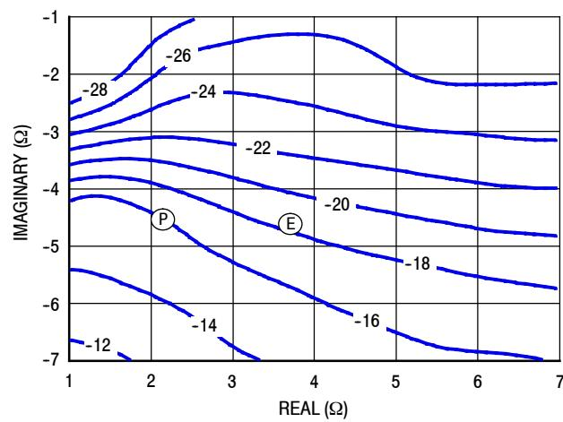
Figure 19. P1dB Load Pull AM/PM Contours (°)
