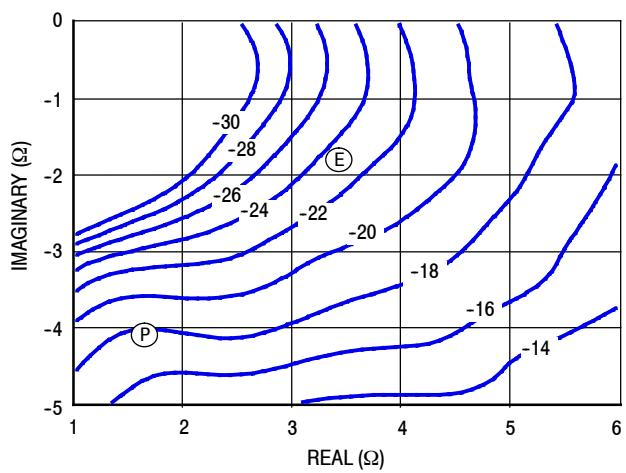
Figure 15. P3dB Load Pull AM/PM Contours (°)
