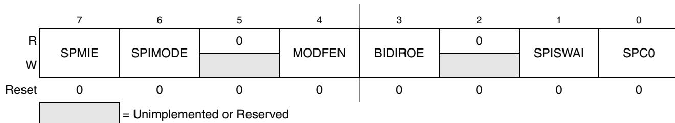
Figure 15-6. SPI Control Register 2 (SPIxC2)
