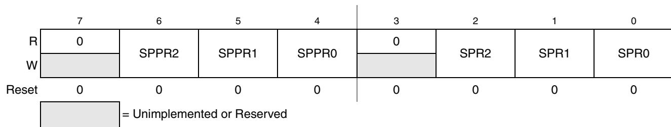
Figure 15-7. SPI Baud Rate Register (SPIxBR)
