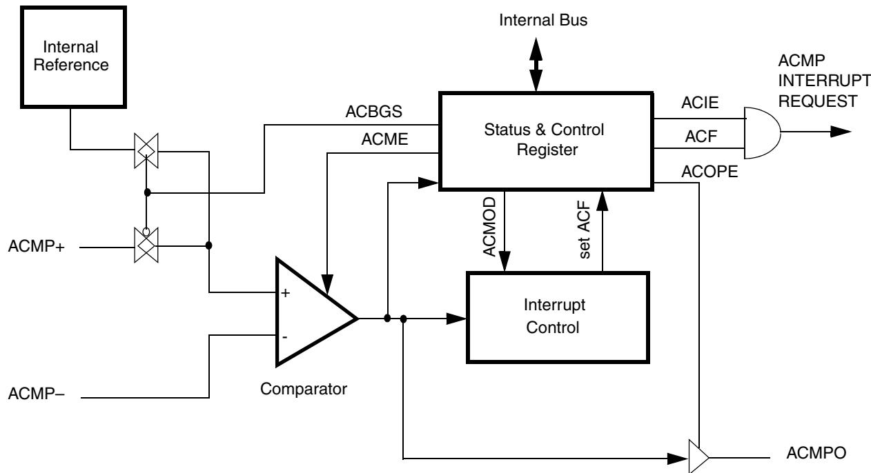
Figure 8-2. Analog Comparator 5V (ACMP5) Block Diagram
