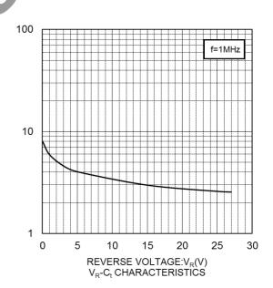
CAPACITANCE BETWEEN TERMINALS:C<sub>(</sub>(pF)
