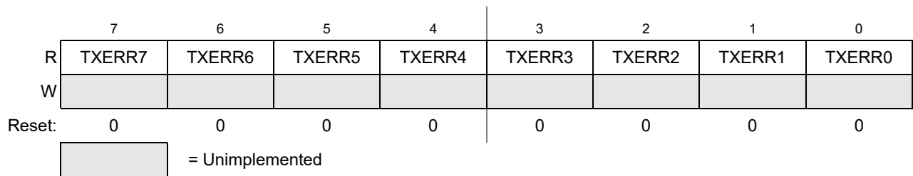
Figure 18-19. MSCAN Transmit Error Counter (CANTXERR)
