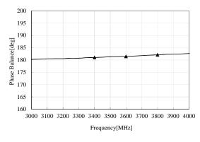
3400 MHz 181 deg 3600 MHz 181 deg 3800 MHz 182 deg
