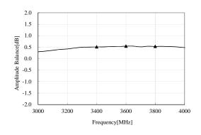
3400 MHz 0.51 dB 3600 MHz 0.55 dB 3800 MHz 0.53 dB
