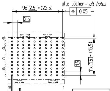
1) Ø0,6±0,05 Durchmesser des metallisierten Loches Ø0,6±0,05 diameter of finished plated-through hole
