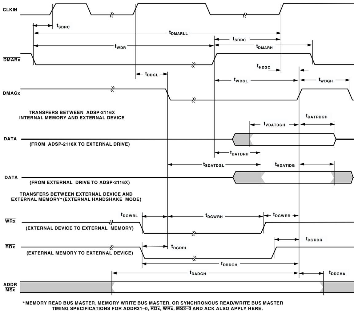
Figure 21. DMA Handshake
