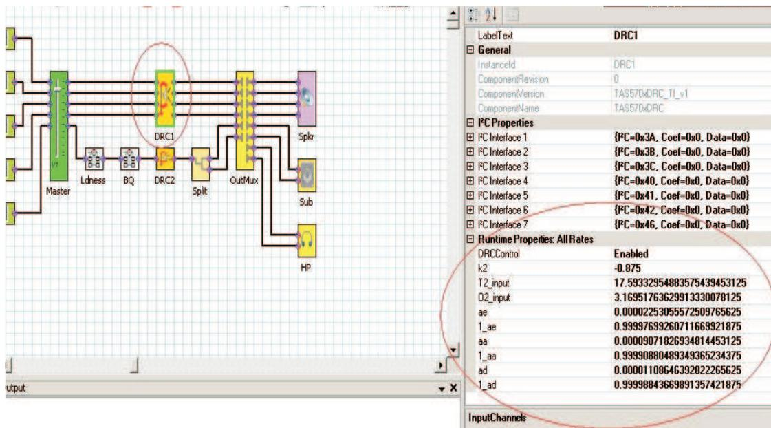
Figure 16. DRC Parameters
