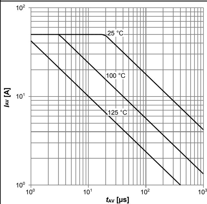
$I_{AS}=f(t_{AV})$ ;  $R_{GS}=25 \Omega$ ; parameter:  $T_{j(start)}$
