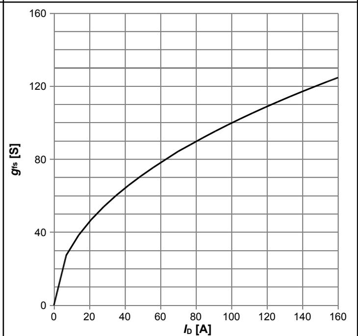
$g_{fs}=f(I_D)$ ;  $T_j=25\text{ }^\circ\text{C}$
