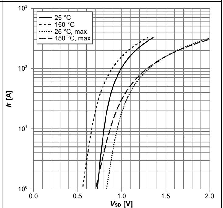
$I_F=f(V_{SD})$ ; parameter:  $T_j$
