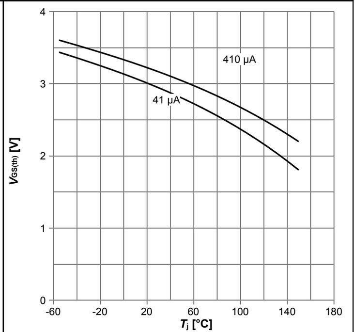
$V_{GS(th)}=f(T_j)$ ;  $V_{GS}=V_{DS}$
