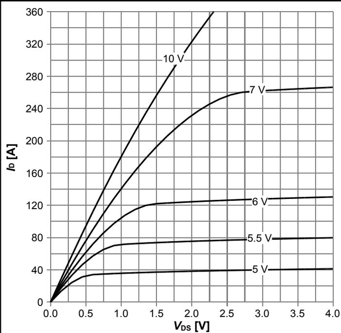
$I_D=f(V_{DS})$ ;  $T_j=25\text{ }^\circ\text{C}$ ; parameter:  $V_{GS}$
