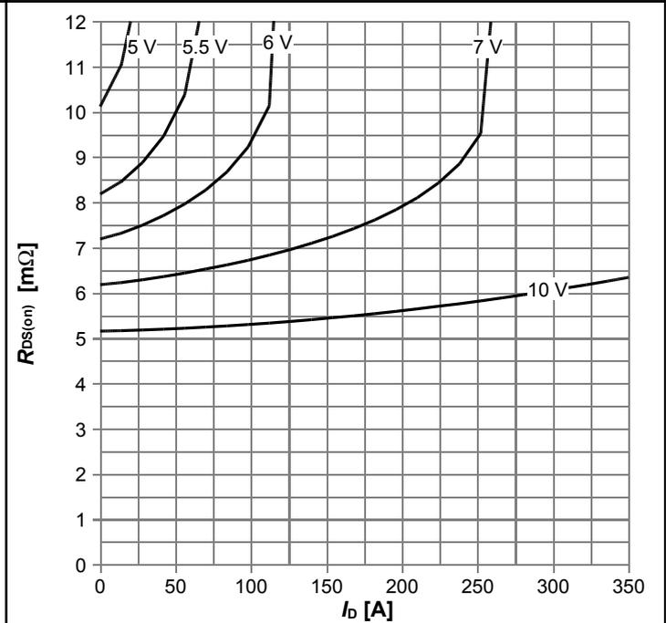
$R_{DS(on)}=f(I_D)$ ;  $T_j=25\text{ }^\circ\text{C}$ ; parameter:  $V_{GS}$
