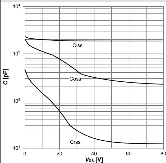
$C=f(V_{DS})$ ;  $V_{GS}=0$  V;  $f=1$  MHz
