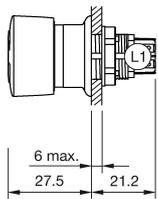
L1 = Löt-/Steckanschluss 2.8 x 0.5 mm
