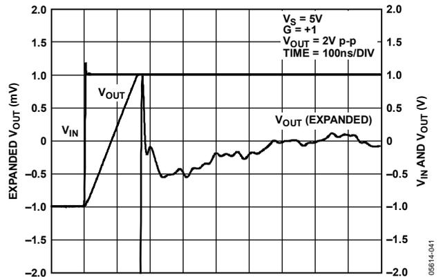
Figure 28. Settling Time
