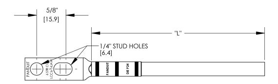
FACTORY CRIMPED #6 AWG/16mm SQ. JUMPER WIRE ASSEMBLY (QTY. 1) INCLUDES: LCC6-14JAW (QTY. 1) #6 AWG/16mm SQ. WIRE - GREEN/YELLOW INSULATION
