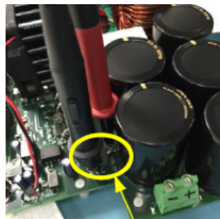
Probing tips: Low side MOSFET V_{GS} and V_{DS}
