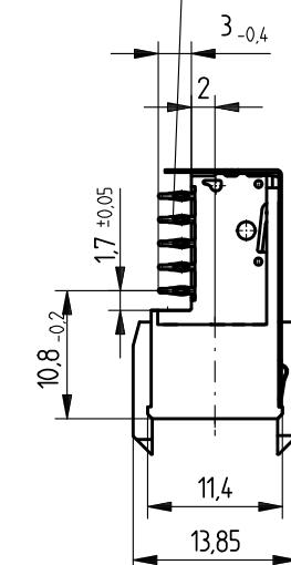
1)  $\varnothing 0,6 \pm 0,05$  Durchmesser des metallisierten Loches
