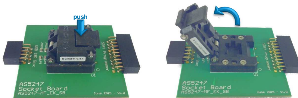
Figure 3: open ZIF socket
