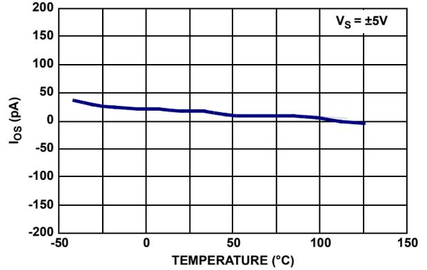
FIGURE 18. OFFSET CURRENT vs TEMPERATURE, V<sub>S</sub> = ±5V
