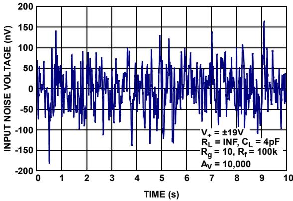
FIGURE 33. INPUT NOISE VOLTAGE 0.1Hz TO 10Hz
