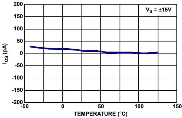
FIGURE 17. OFFSET CURRENT vs TEMPERATURE, V<sub>S</sub> = ±15V
