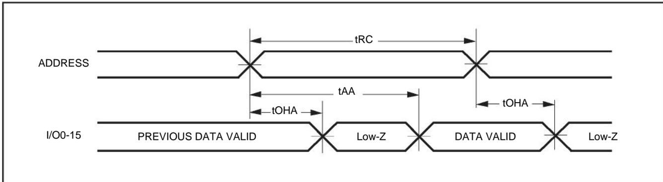
**READ CYCLE NO. 2<sup>(1,3)</sup> ( $\overline{CS1}$ ,  $CS2$ , AND  $\overline{OE}$  CONTROLLED)**
