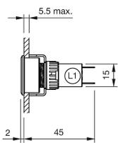
P = Steckanschluss 2.8 x 0.5 mm
