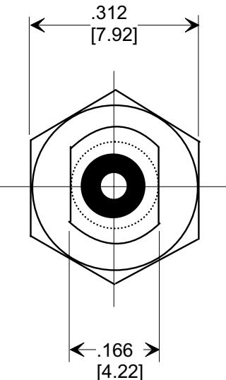
MAXIMUM TIGHTENING TORQUE - 8 IN. LBS.
