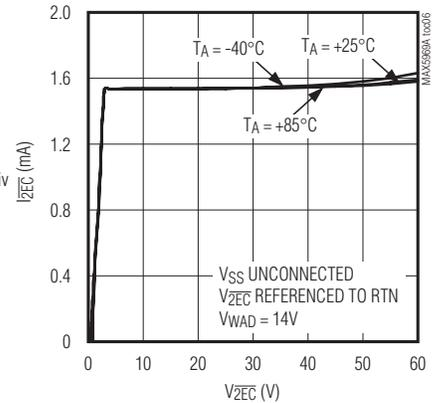
**PG SINK CURRENT vs. PG VOLTAGE**
