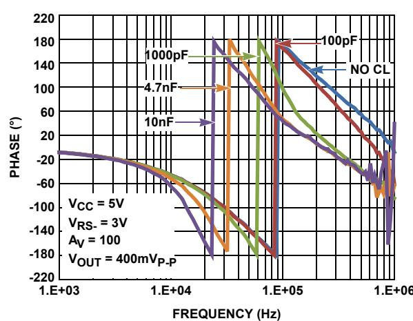
FIGURE 20. CAPACITIVE LOAD DRIVE PHASE vs FREQUENCY
