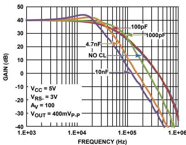
FIGURE 19. CAPACITIVE LOAD DRIVE GAIN vs FREQUENCY
