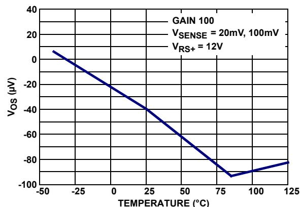
FIGURE 18.  $V_{OS}$  ( $\mu$ V) vs TEMPERATURE
