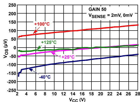
FIGURE 26. V<sub>OS</sub> vs V<sub>CC</sub>,  $V_{RS+} = 12V$
