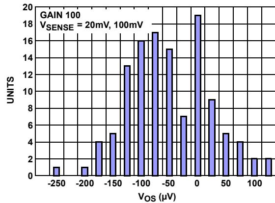
FIGURE 7.  $V_{OS}$  ( $\mu V$ ) DISTRIBUTION AT  $+25^\circ C$ ,  $V_{RS+} = 12V$ ,
