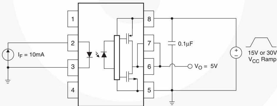
**Figure 28. UVLO Test Circuit**
