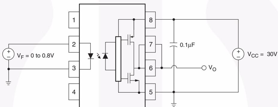
**Figure 25.  $I_{CCL}$  Test Circuit**
