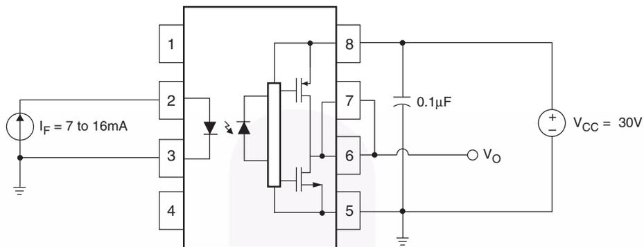
**Figure 24.  $I_{CCH}$  Test Circuit**
