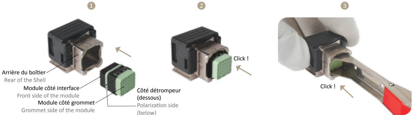
**1** Présenter le module côté interface à l'arrière du boîtier du connecteur, en face de la cavité présentant le bon détrompage (le module standard N pouvant être utilisé dans toutes les cavités).
