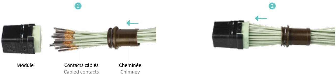
**1** Passer les cheminées sur les faisceaux avant l'insertion des contacts câblés dans les modules.
