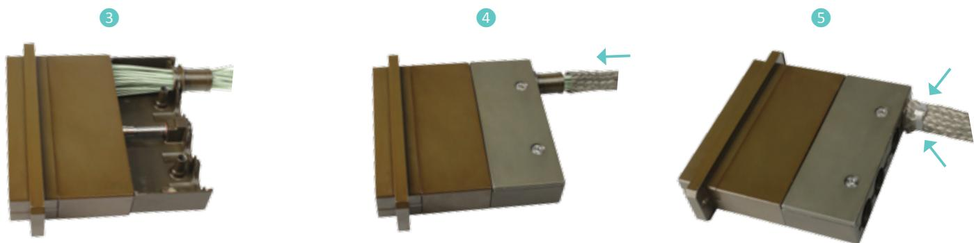
**3** Placer les modules dans le boîtier (voir procédure page 105) et assembler les capots arrières (voir procédure page 108).
