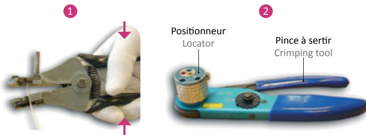
1 Les câbles doivent être dénudés au moyen d'un outil approprié pour éviter de blesser l'âme et la gaine isolante. Dénuder le câble sur une longueur correspondant à la cote de perçage du fût de contact.
