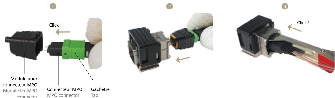
**1** Présenter le connecteur MPO face au module et le pousser à l'intérieur jusqu'au clic de verrouillage.
