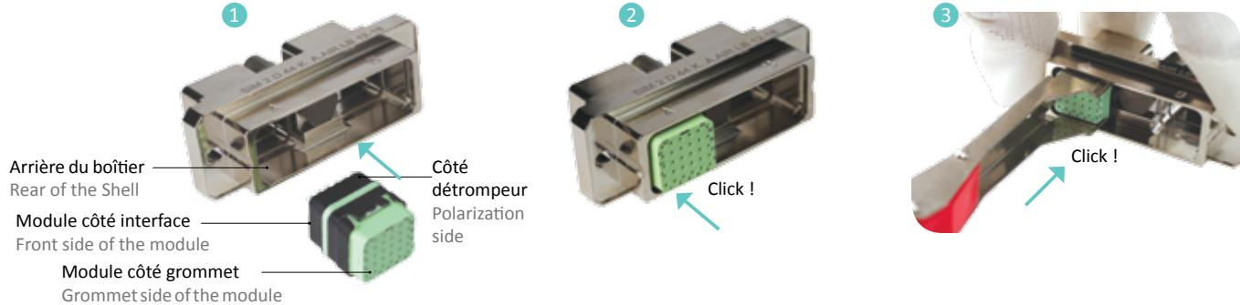
**1** Présenter le module côté interface à l'arrière du boîtier du connecteur, en face de la cavité présentant le bon détrompage (module détrompé A dans la cavité A, module détrompé B dans la cavité B ... le module standard N pouvant être utilisé dans toutes les cavités).
