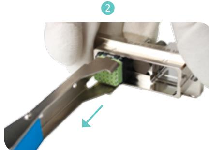
**1** Présenter l'outil côté arrière du boîtier. Pousser lentement l'outil le long des parois du module jusqu'à ce qu'il rencontre une butée franche. A cet instant, les clips de rétention du module se trouvent déverrouillés.
