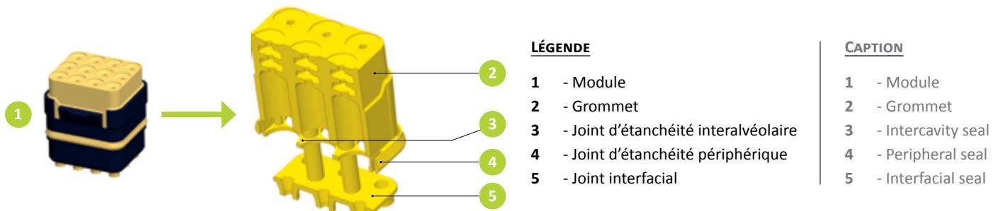
Les modules sont conçus pour recevoir des contacts à sertir répondant aux normes SAE-AS39029 et EN3155.
